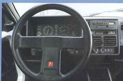
Si le compte-tours a vite rejoint l'instrumentation, rien ne renseigne sur la pression et la température d'huile.
