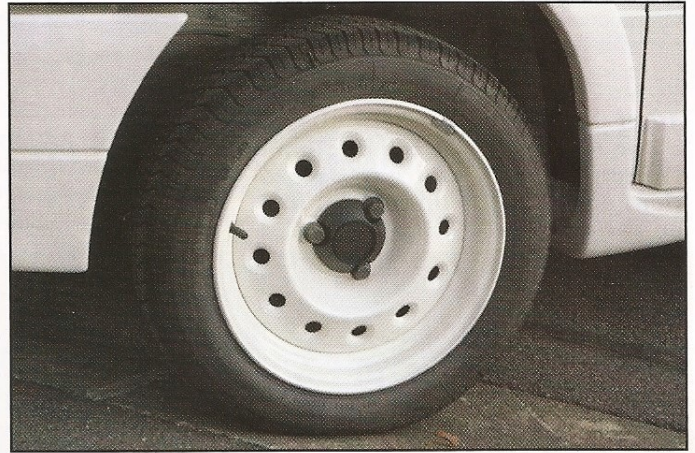
L'AX Sport du Conservatoire est un modèle de présérie. Dans le détail, ses jantes ne sont pas exactement identiques à celles de série. Les premières AX avaient des jantes de treize pouces.
