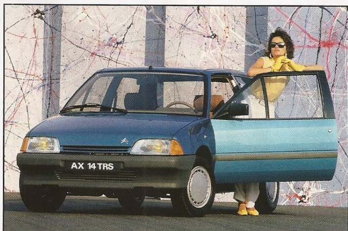
Avec son moteur de 65 ch, pour un poids plume, l'AX 14 TRS est déjà plus étoffée. Sa présentation reste semblable à celle de la 11 TRE. Toutefois, la boîte à cinq vitesses est de série.
