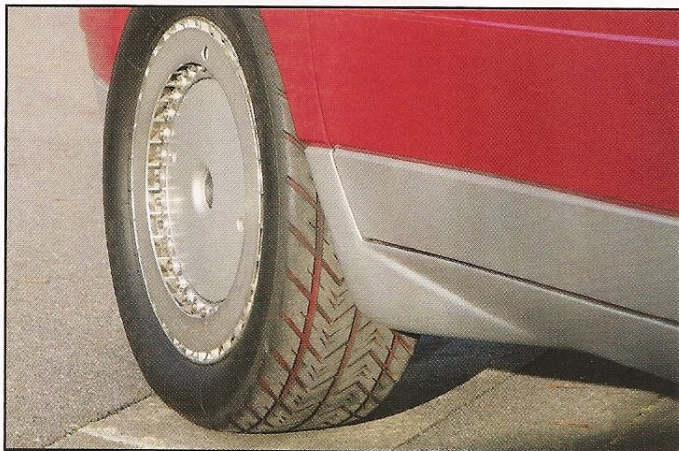
La profondeur de l'empreinte du pneu est peinte en rouge et la gomme arbore le double chevron. Ces pneus ont été réalisés sur mesure par Michelin pour ce prototype de salon.
