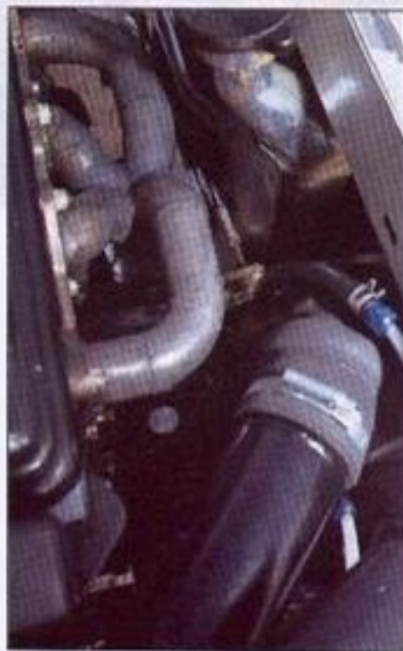
Le 1 360 bloc alu reçoit une injection Marelli, un turbo Garrett avec échangeur et une suralimentation à la carte!
